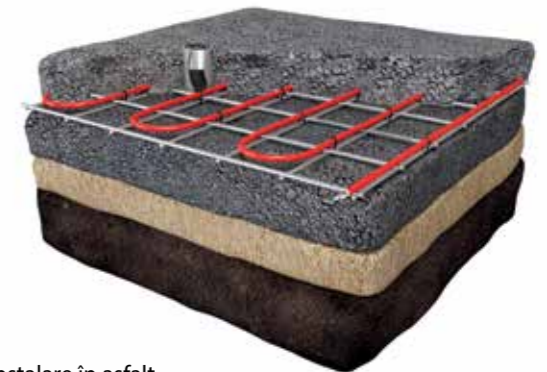
Instalare în asfalt
